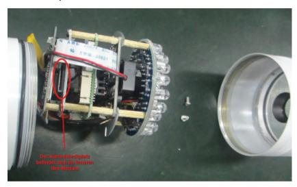
4. Bitte schieben Sie das Modul in das Gehäuse zurück und befestigen Sie es mit den beiden zuvor gelösten Schrauben.
