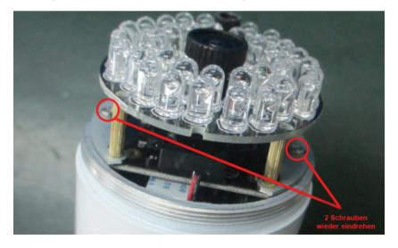
Verschließen Sie das Gehäuse bitte wieder. Bitte achten Sie darauf, dass die Gummidichtung gerade sitzt und nicht verknickt oder verschoben wird. Ansonsten kann die Dichtigkeit des Gehäuses nicht gewährleistet werden.
